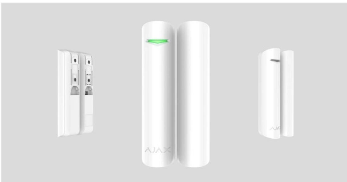
**DoorProtect** — беспроводной датчик открытия дверей и окон, предназначенный для использования внутри помещений. Работает до 7 лет от комплектной батареи, оснащен герконом, обрабатывающим более миллиона открытий. Имеет разъем для подключения внешнего датчика.
