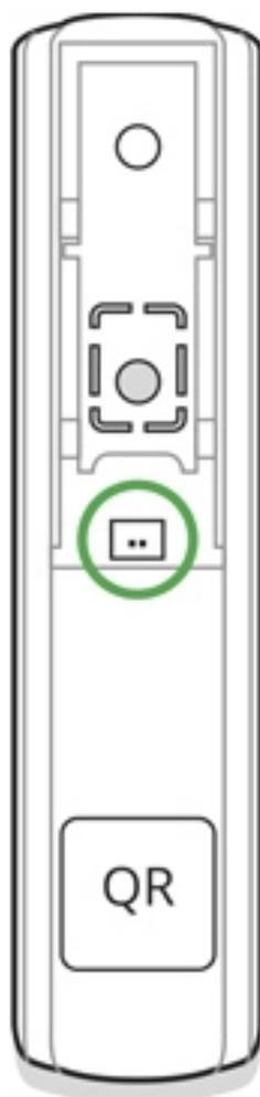
Мы рекомендуем устанавливать проводной датчик на расстоянии не более 1 метра – увеличение длины провода повышает шанс его повреждения и ухудшает качество связи между датчиками.
